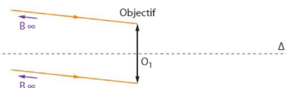
L'objectif a une distance focale  $f'_1 = 20 \text{ cm}$  et la lentille oculaire, non représentée, a une distance focale  $f'_2 = 5,0 \text{ cm}$ .
