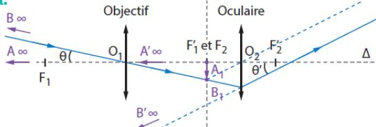
La lunette est afocale de sorte que le foyer objet  $F_1$  de l'oculaire est confondu avec le foyer image  $F'_1$  de l'objectif :  $O_2F'_1 = O_2F_1 = O_2A_1$ .
